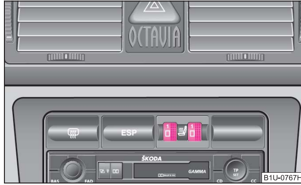
صورة (٦٣) - لوحة القيادة: الزر الدوار لتدفئة المقاعد الأمامية
