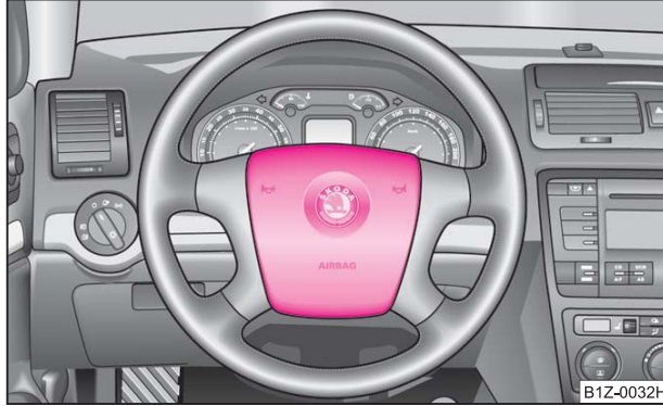
صورة (١١٧) - الوسادة الهوائية للسائق في المقود
