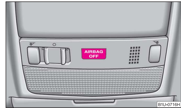
صورة (١٢٤) - إشارة كنترول إيقاف عمل الوسادة الهوائية للراكب الأمامي
