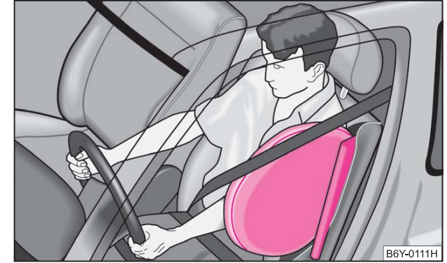
صورة (١٢٢) - الوسادات الهوائية الجانبية المملوءة بالغاز
