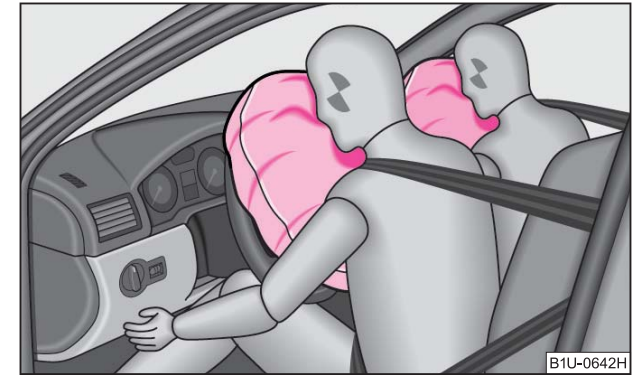
صورة (١١٩) - الوسادات الهوائية المملوءة بالغاز
