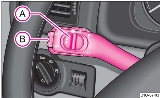
صورة (١٠٤) - ذراع الاستعمال: الزر الأرجوحى ومفتاح جهاز تثبيت السرعة
