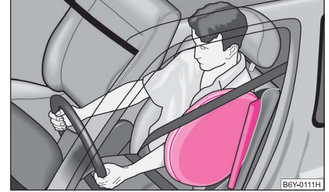
صورة (١٦٩) - الوسادات الهوائية الجانبية المملوءة بالغاز
